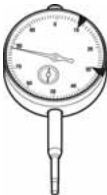
VAS 6079 Messuhr Einstellung von OT des 1. Zylinders
